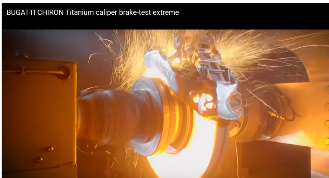
BUGATTI CHIRON Titanium caliper brake-test extreme
