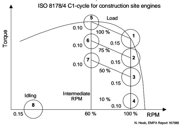
**Fig. 4:** Used Test cycle ISO 8178/4 C1
