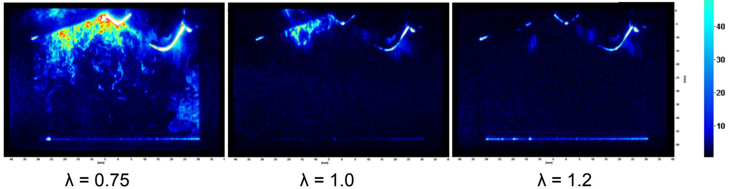
[ $n=2000\text{rpm}$ ;  $p_{\text{intake}}=380\text{mbar}$ ;  $p_{\text{rail}}=100\text{bar}$ ;  $\text{SOI}=-360^{\circ}\text{aTDC}$ ;  $\text{Ignition}=-20^{\circ}\text{aTDC}$ ; neutral;  $T_{\text{Engine}}=20^{\circ}\text{C}$ ]
