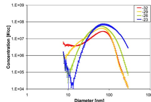
FIGURE 7. PARTICLE SIZE DISTRIBUTION MEASUREMENTS FOR MULTIPLE INJECTION TIMINGS FROM A LIGHT DUTY DIESEL ENGINE OPERATING IN THE PREMIXED LOW TEMPERATURE COMBUSTION REGIME.
