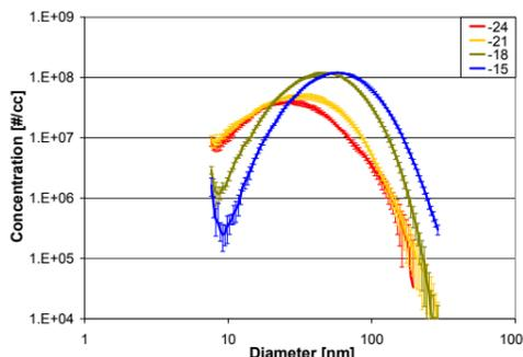
FIGURE 6. PARTICLE SIZE DISTRIBUTION MEASUREMENTS FOR MULTIPLE INJECTION TIMINGS FROM A HEAVY DUTY DIESEL ENGINE OPERATING IN THE PREMIXED LOW TEMPERATURE COMBUSTION REGIME.[9]
